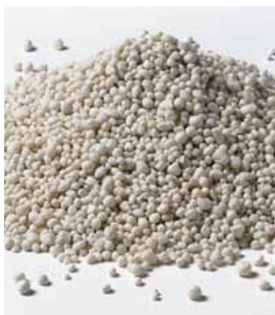
Het glasgranulaat wordt met bindmiddel tot de StoReno Plan plaat gevormd.
